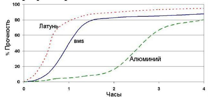
Время затвердевания рассматривается обычно при 23°C. Меди и ее сплавом соответствует более быстрое затвердевание, чем окисленным или пассивным поверхностям, таким как нержавеющая сталь, которая имеет тенденцию к более медленному затвердеванию. Чем ниже температура или чем шире зазор, тем больше время затвердевания. Для сокращения времени затвердевания можно либо использовать Permabond A905, либо высокую температуру, по выбору.
