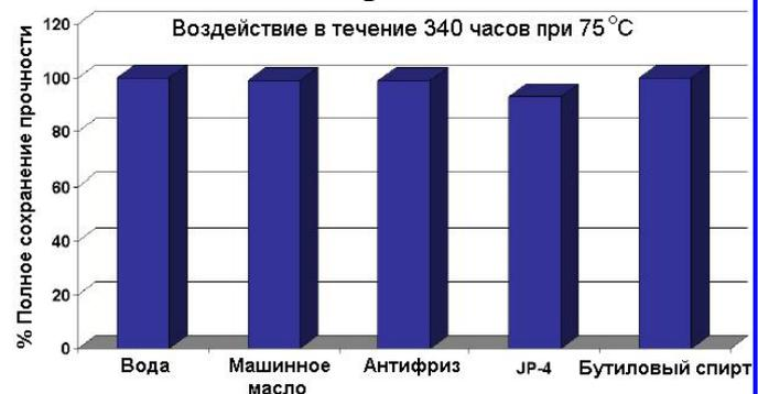
Этот продукт не рекомендуется использовать в соединениях, которые будут контактировать с паром или с чистым кислородом. Следует избегать длительного контакта с сильными кислотами, щелочами и сильно полярными растворителями.
