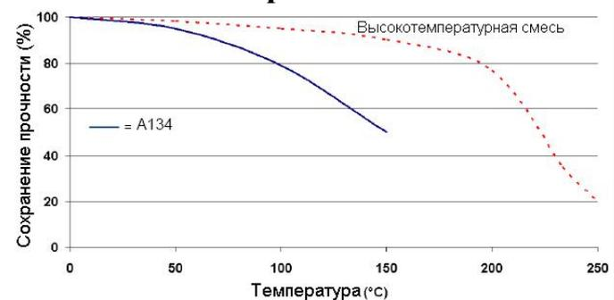
Уменьшение прочности обратно пропорционально охлаждению при условии, что место соединения не перегружено. Кратковременное воздействие более высоких температур может быть приемлемо.
